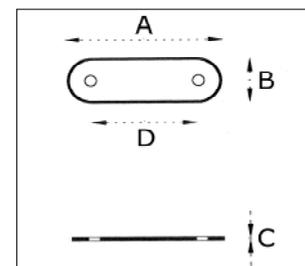
**REFUERZO METÁLICO PARA PUENTES REF. 410-411 EN ACERO ZINCADO**
